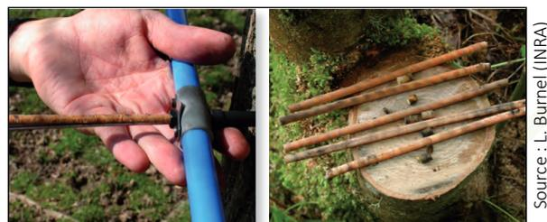
Figure 5 : Carottage à la tarière de Pressler et carottes post-extraction.
