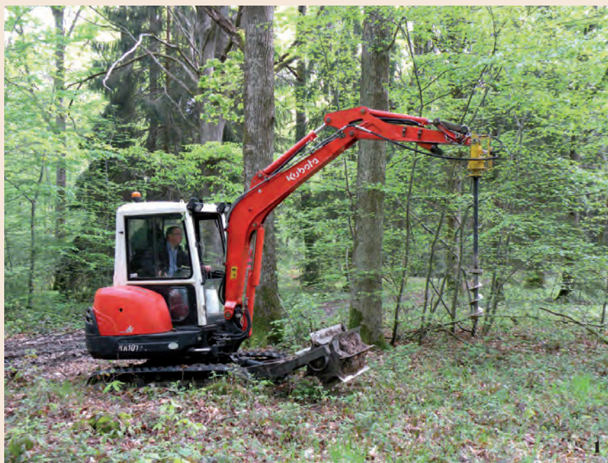
La tarière Antec MD, suspendue au bras d'une chenillette Kubota, équipée à l'avant d'un rouleau landais.
