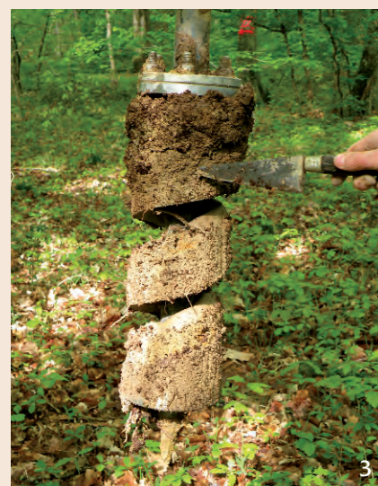
Carotte de sondage effectuée à l'aide de la tarière hydraulique.
