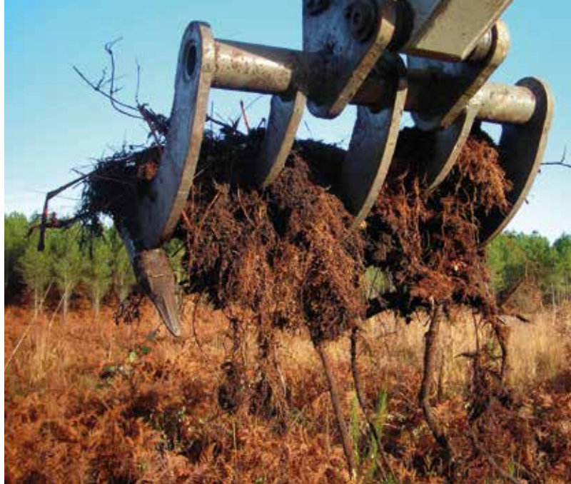
Arrachage de rhizomes de fougère au scarificateur réversible® Becker monté sur mini pelle. Léon Wehrle © Inra
