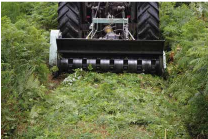
Broyeur à axe horizontal sans rotation roulant au sol. Christophe Vidal - IDF © CNPF
