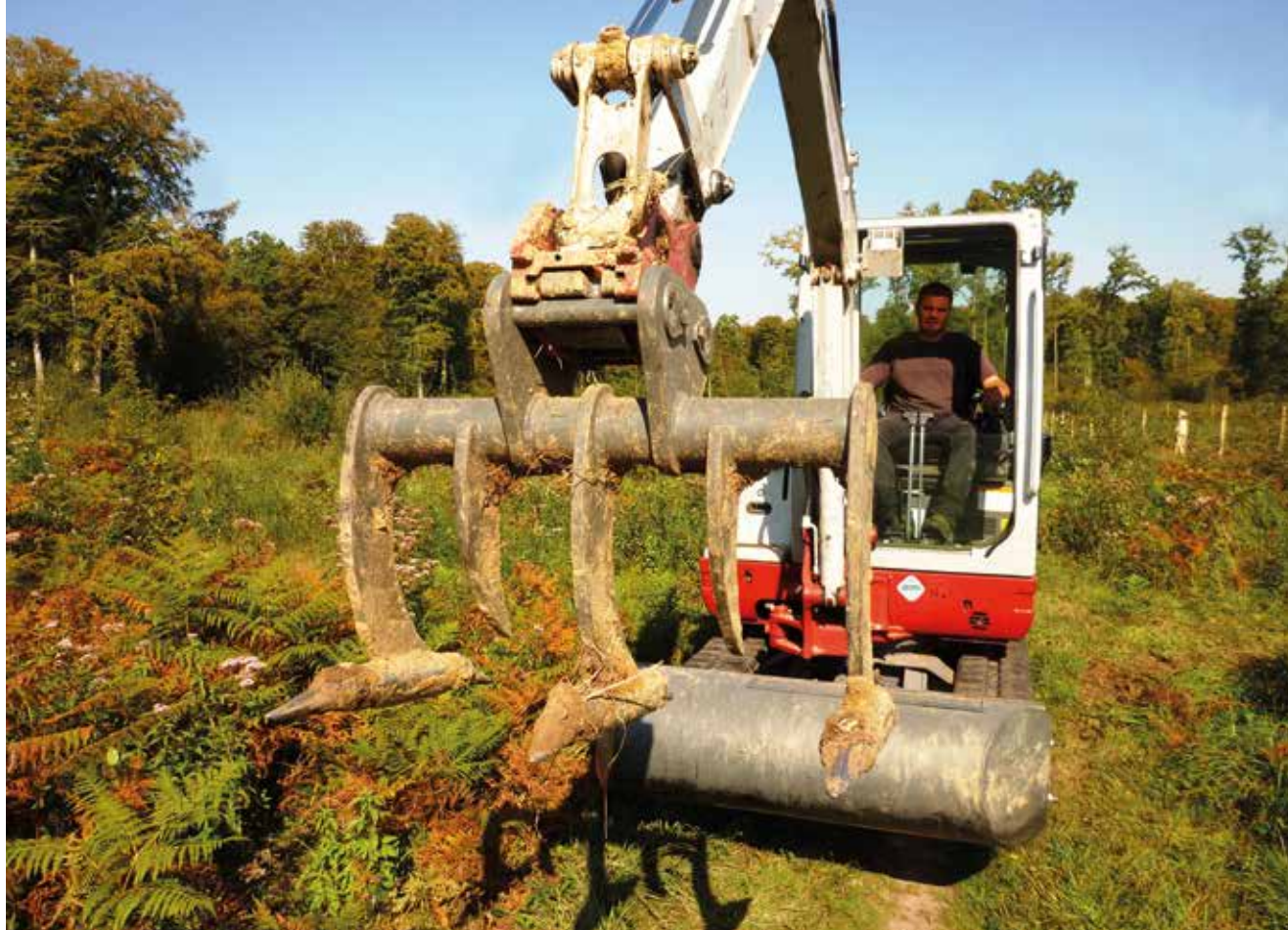
Le Scarificateur réversible® Becker sur minipelle. Léon Wehrlen © Inra
