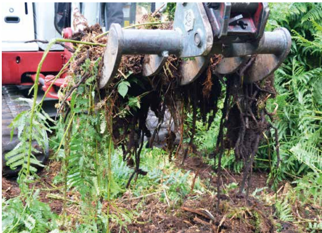
Arrachage de rhizomes profonds par le scarificateur réversible®. Léon Wehrlen © Inra
