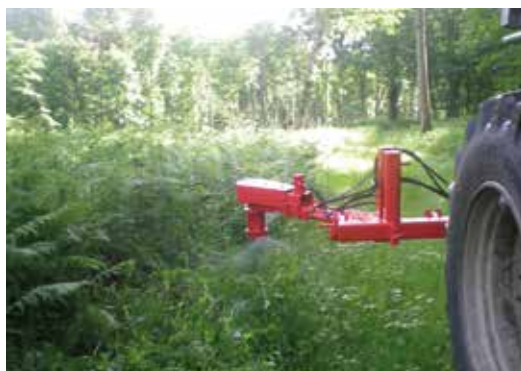
Prototype de bâtonneur mécanisé de Grenier-Franco. Bernard Costenoble © ONF
