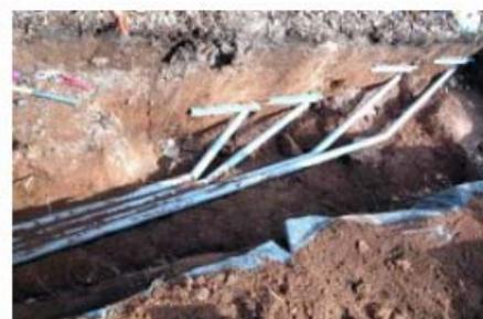
Recueil des eaux du sol au moyen de bougies poreuses (à gauche) et installation de plaques lysimétriques dans le sol (à droite). Les solutions du sol sont recueillies dans les flacons (ci-dessous)
