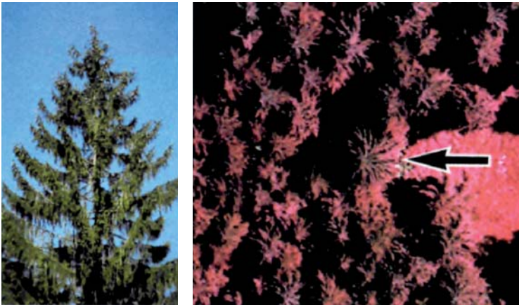
Fig. 2 : Effet d'une défoliation sévère d'un Épicéa sur un cliché infrarouge couleur. À gauche : vision depuis le sol, à droite, vue sur un cliché aérien en infrarouge couleur. (Extrait du guide européen « Remote Sensing Applications for Forest Health Status Assessment » - second edition)
