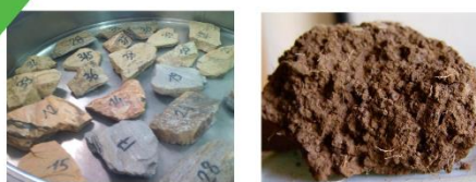
Mesures de rétention en eau sur échantillons de cailloux et mottes de terre fine
