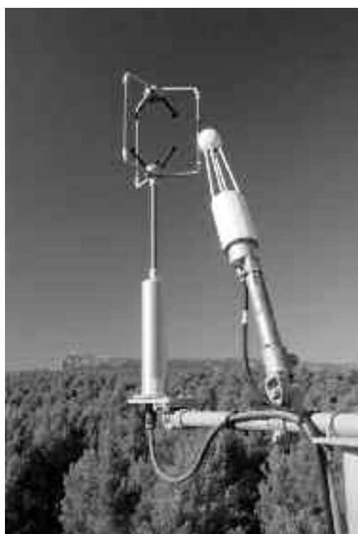
Photo 1 : Capteurs d'eddy covariance situés sur la tour à flux, au dessus du couvert.
