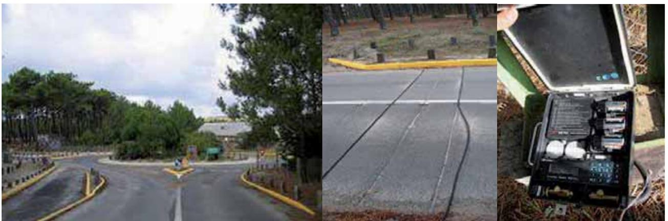
Fig. 2 : compteur routier à l'entrée du plan plage du Gressier (Le Porge, 33)
