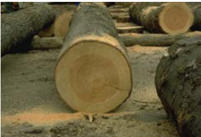
Section de grume de douglas mettant en évidence la largeur d'aubier de l'arbre, correspondant à la zone claire sous l'écorce.
