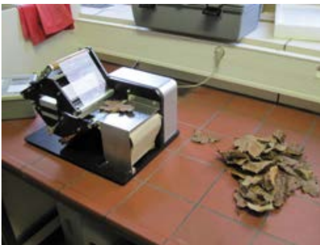
Planimètre à bande utilisé pour la mesure de la surface foliaire de feuilles de chêne au laboratoire.
