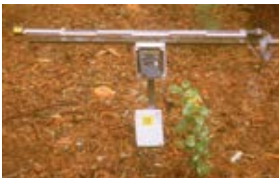
Capteur linéaire d'un mètre de long (Delta-T Devices, Cambridge, UK) permettant de mesurer le rayonnement solaire global sous le couvert forestier.
