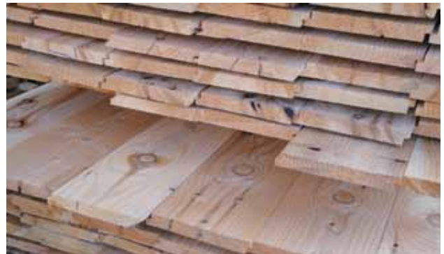
38 - Le cèdre est particulièrement adapté aux usages extérieurs (ici des lames de bardage).
